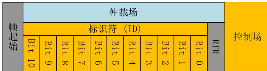
图 1-59 can 报文结构 2
