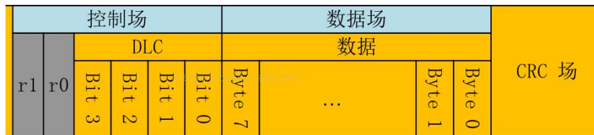
图 1-60 can 报文结构 3
