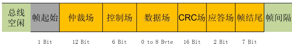
图 1-58 can 报文结构 1
